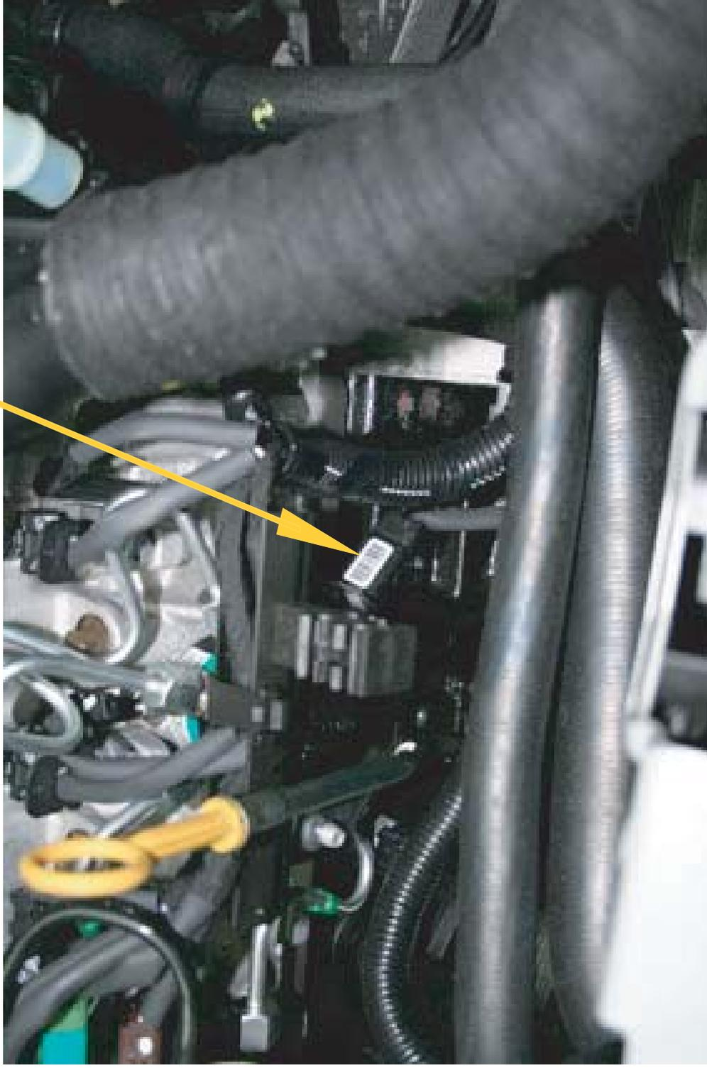
**Astuce pour trouver la rampe commune :** Partez d'un injecteur et suivez le petit tuyau métallique (arrivée de carburant). Ce petit tuyau métallique aboutit sur la rampe commune. Sur cette rampe commune, se trouve le capteur à 3 fils.
